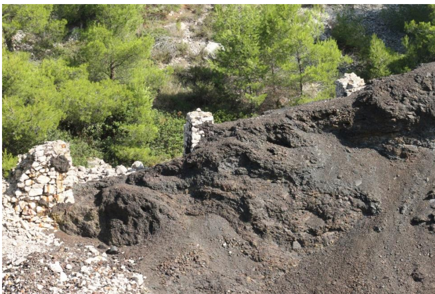
L'Escalette : le terril et les piles supportant les rails pour les wagonnets
